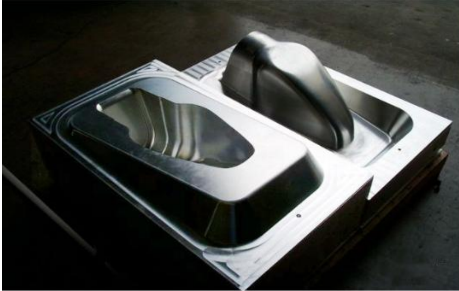
Σχήμα 3.2: Παράδειγμα κατασκευής καλουπιού με χρήση πενταξονικής φραιζας [6]
