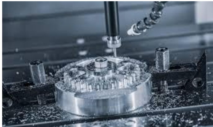
Σχήμα 3.4: Κατεργασία αφαίρεση υλικού με χρήση CNC φραιζας
