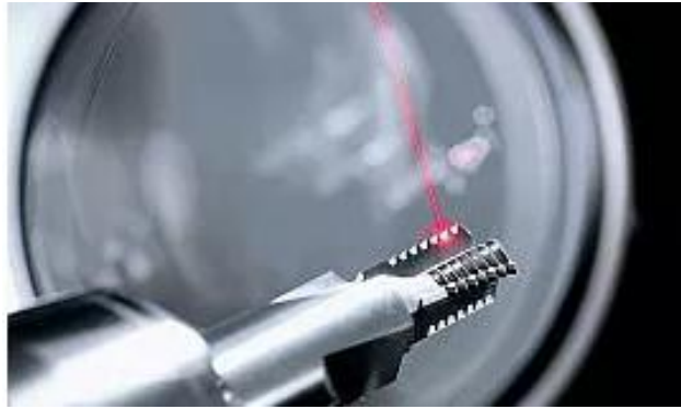
Σχήμα 3.8: Κατασκευή εργαλείου σπειροτόμησης με Lasertec 20 PrecisionTool [17]
